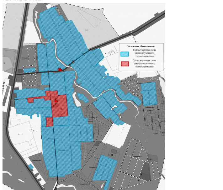
Рис. № 2 – Зоны действия Централизованной котельной, АГК пожарного депо и индивидуальных источников тепловой энергии существующей жилой застройки на территории села Нижнее Санчелеево
